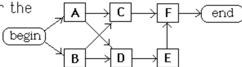
Maximize  $d_A X_{AC} + d_B X_{BC} + d_A X_{AD} + \dots + d_F X_{F,end}$
